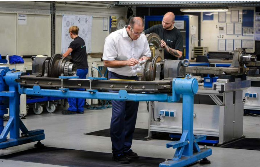
Blick in die neue Service Halle – Aufarbeitung von Losradachsen und Fahrwerken.
