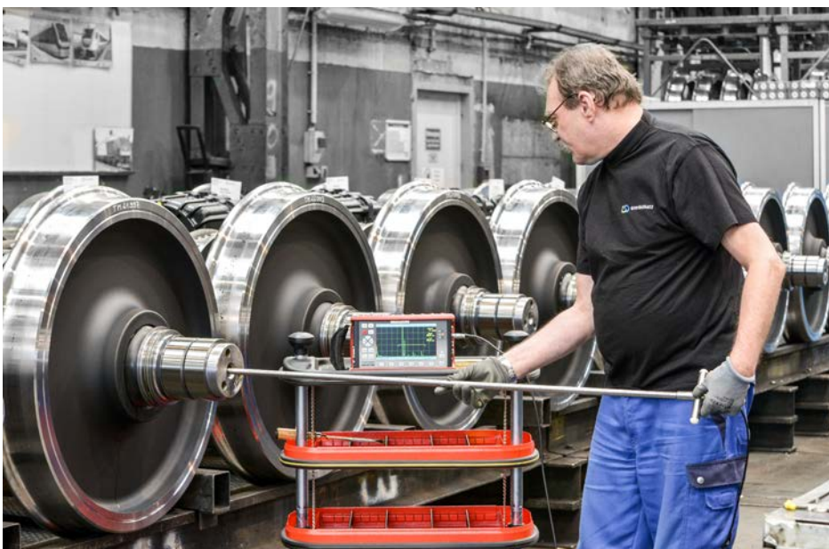
Safety-First – Ultraschallprüfung von instandgesetzten Radsätzen.
