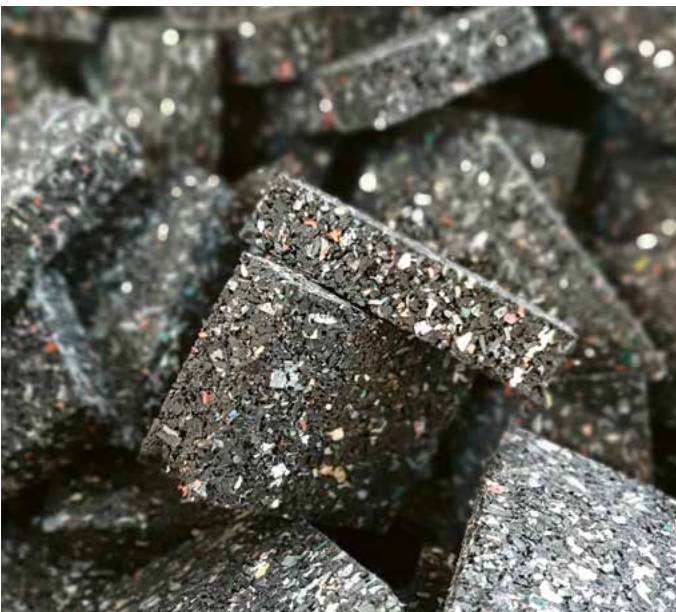
Isopads aus 95 % Altreifengranulat
