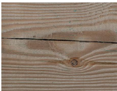
Spannungsrisse durch die Holz Trocknung
